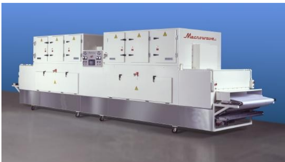
รูปที่ 1.3: แสดงตัวอย่างเตาให้ความร้อนด้วยคลื่นวิทยุ
